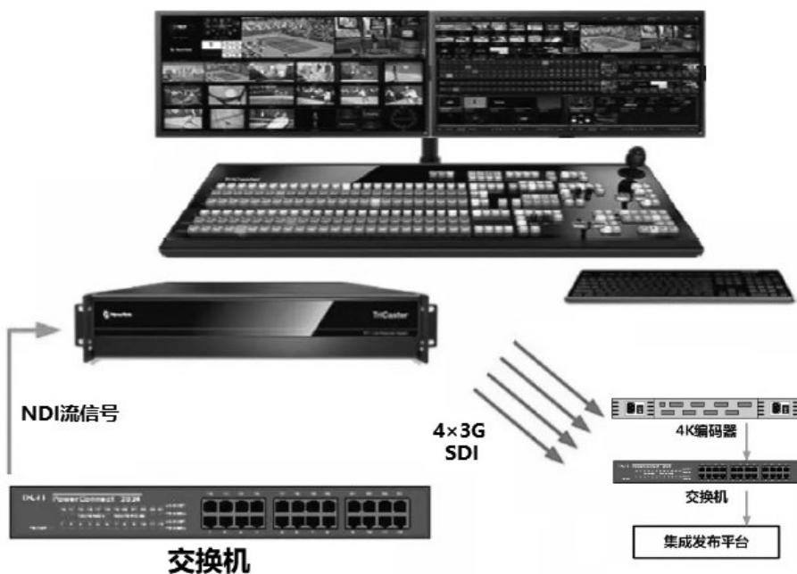
图4 IP切换制作及播出示意图
